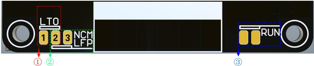
此款均衡板出厂默认适用于 NCM 三元锂和 LFP 铁锂电池。
